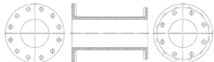
Unique Drill Patterns per flange
